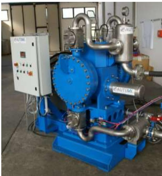
Per assicurare una perfetta diagnostica di funzionamento, sono presenti canali di segnalazione in caso di rottura della membrana.
