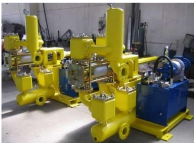
Il pistone a doppio effetto a comando idraulico, intorno al quale sono costruite le pompe della serie Dragon, è stato pensato con particolare attenzione per l'impiego nell'alimentazione di filtropresse a piastre e per il trasporto dei liquidi industriali con possibilità di operare in un range di temperature che vanno dai -10 ai 80° C.
